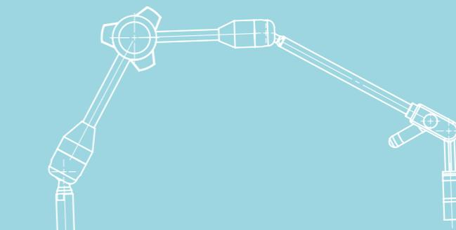
Der „**Quick Lock**“ ist ein universeller **Gelenkarm** mit großem Schwenkbereich. Er dient der Aufnahme von Schläuchen und Kabeln. Bis zu **3 Gelenke** lassen sich mit geringem Kraftaufwand gleichzeitig durch einen zentralen **Sterngriff** in der optimalen Arbeitsposition fixieren.
